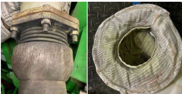
Cr-6 Ablagerungen auf einem Kompensator (gelbliches Pulver)
